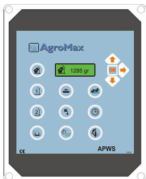
Весы монтируются посредством крепления к потолку цеха. Они могут легко демонтироваться при уборке цеха и подсоединяются к весовому компьютеру при помощи трехжильного кабеля. Компьютер регистрирует и отображает следующую информацию:
