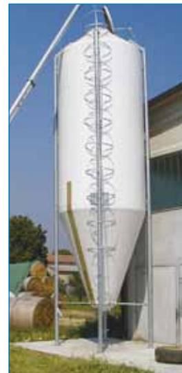
Модульная конструкция обеспечивает удобство перевозки силосохранилища, поскольку оно поставляется в разобранном виде.
